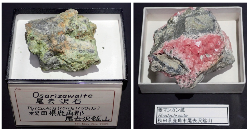
図3 鉱山から得られた鉱物標本の例. 秋田県尾去沢鉱山. 左:尾去沢石. 右:菱マンガン鉱.
