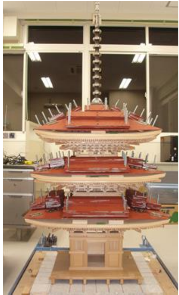
構造実験に用いた三重塔の縮小模型(左:鍾なし、右:鍾あり)
